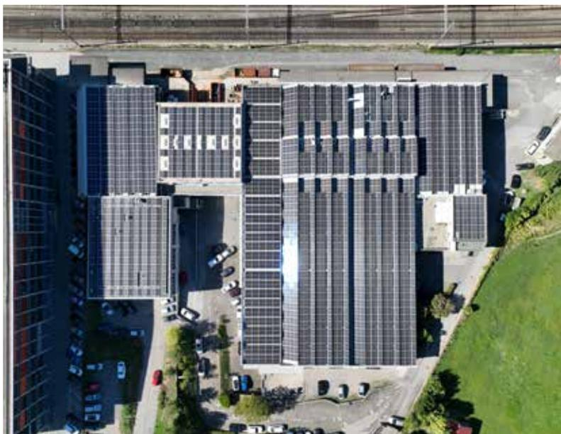
un programma volontario della confederazione per abbattere le emissioni di CO<sub>2</sub> e, nel 2022, ha installato 2011 pannelli solari sul tetto (915kWp) che permettono di coprire il 45% del proprio fabbisogno energetico, immettendo in rete il restante 25% di elettricità prodotta dal nostro impianto.
